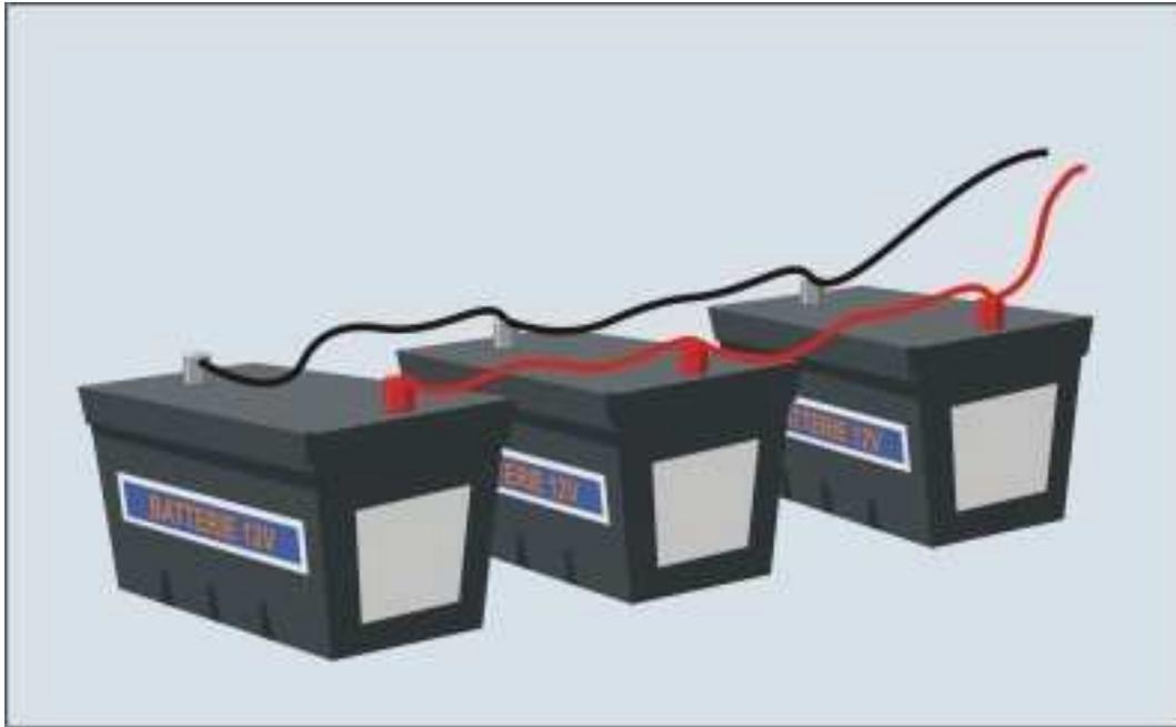
Seulement ... les batteries fonctionnent en basse tension (généralement en 12 Volts) et en courant continu.
